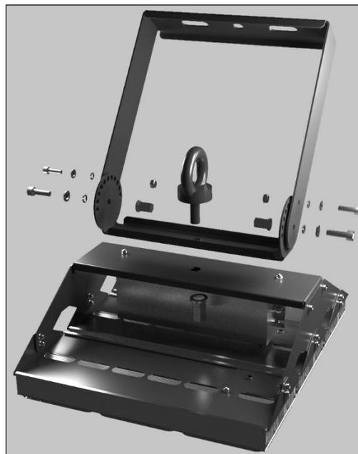
Каждый модуль светильника имеет возможность вращения относительно своей оси на 30° в обе стороны. Фиксация осуществляется винтами М4.
