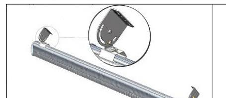
**Накладной способ монтажа при помощи скоб**
