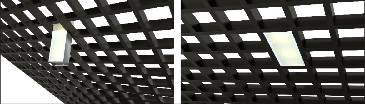
1. Завести светильник под углом в ячейку потолка
